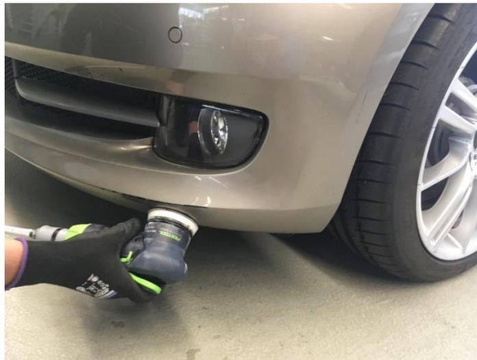
Beurteilung einer Lack Schleifprobe (Beispiel einer werksseitigen Lackierung mit einer Lackfarbe)
